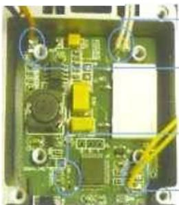
**Белый провод 2шт.** Контакты реле, для подключения электро замка (в разрыв его питания).
