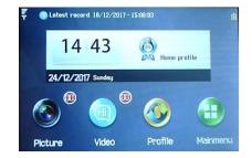
**Phone profile** - режим, когда при нажатии кнопки звонка - идёт вызов на Ваш мобильный и вы сможете разговаривать с посетителем, также делается фото/видео звонящего и фото передаётся по MMS на мобильный. При включенном детекторе движения - делается и записывается фото/видео без звонка и MMS на мобильный.
