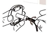
Возьмите шурупы правильного размера и слегка вкрутите их в компонент, устанавливаемый на на-ружной стороне двери. При толщине дверного по-лотна менее 65 мм используйте шурупы длиной 35 мм; при толщине дверного полотна от 65 мм до 95 мм используйте шурупы длиной 65 мм; при топщине дверного полотна более 95 мм следует использовать более длинные шурупы.
