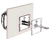
Пропустите гибкий ленточный кабель через центральное отверстие в крепежной пластине и затем вставьте шурупы в отверстия для шурупов.
